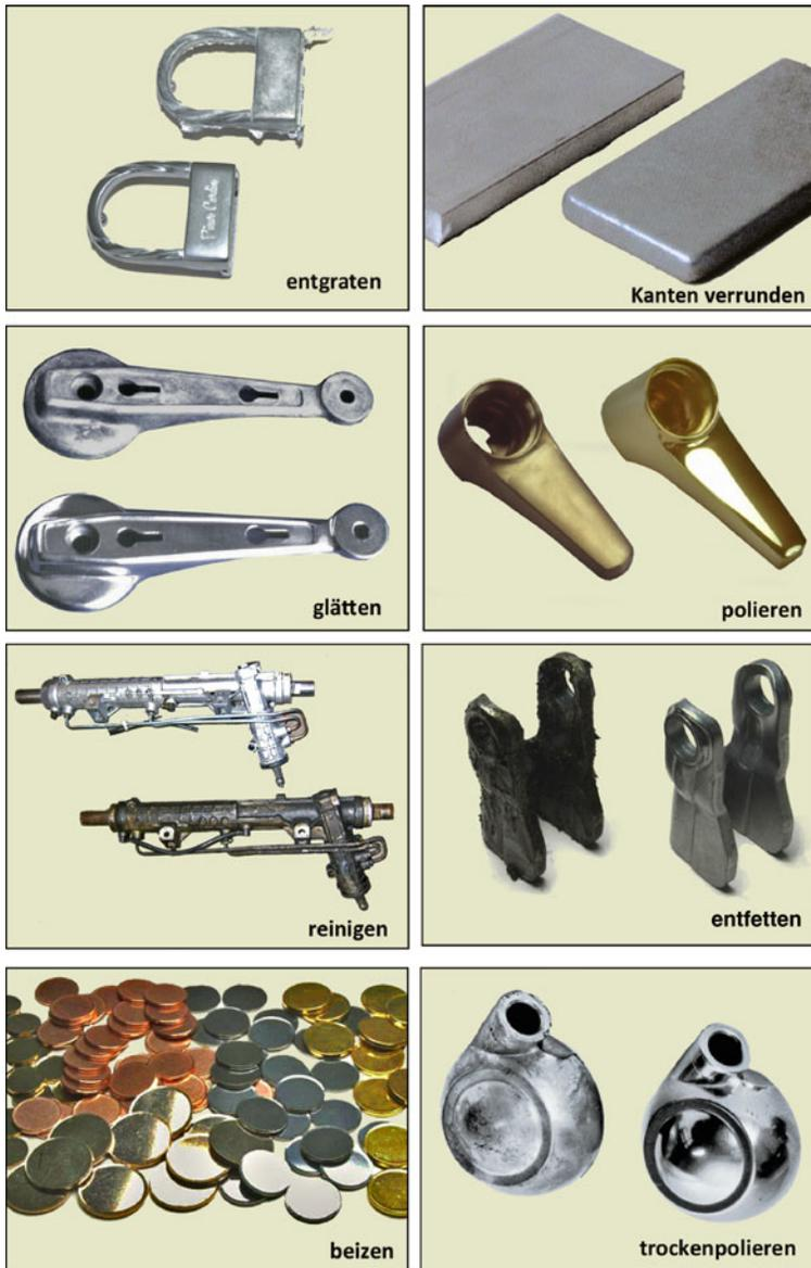
**Abb. 1.5** Beispiele von Gleitschleifbearbeitungen
