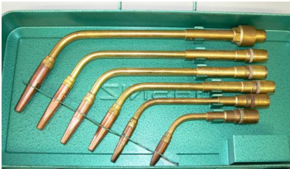
**Abb. 2.4** Schnittzeichnung eines Schweißbrenners nach dem Injektorprinzip. Der Injektor ist nicht verstellbar und gehört zum Brenneinsatz. Dazu ein komplettes Schweißdüsenset.
