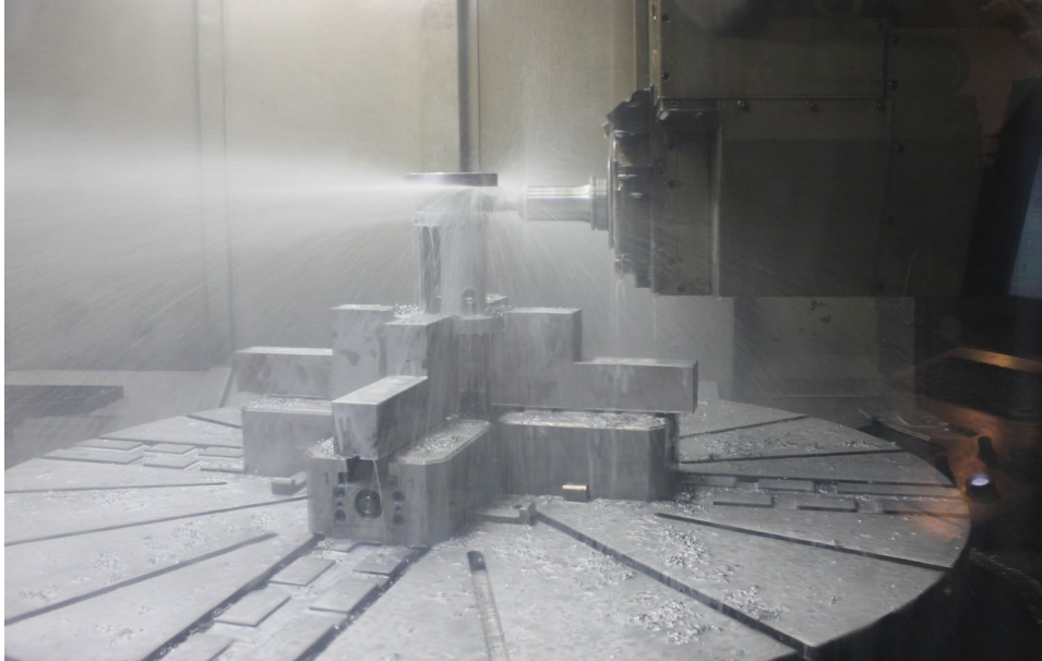
Abb. 1–3 CNC-Fräsmaschine mit drehbarem Maschinentisch (4. Achse)
