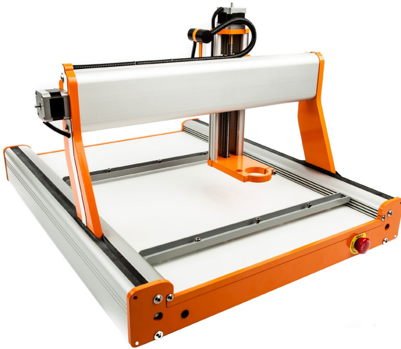
Abb. 1–2 3-Achsen-CNC-Portalfräsmaschine für den Hobbybereich
