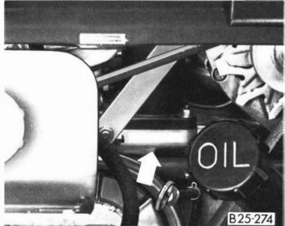
Die Motornummer ist auf der rechten Motorseite am Flansch unter dem Öllüfter eingeschlagen.
