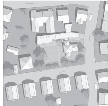
Abbildung 7: Der Anbau steht direkt auf der Grundstücksgrenze und rahmt das Schlösschen ein. Eine schmale Verlängerung des Anbaus bis hin zur Straße bildet den Zugang zu beiden Gebäudeteilen (Bilder: Schluppkotten)
