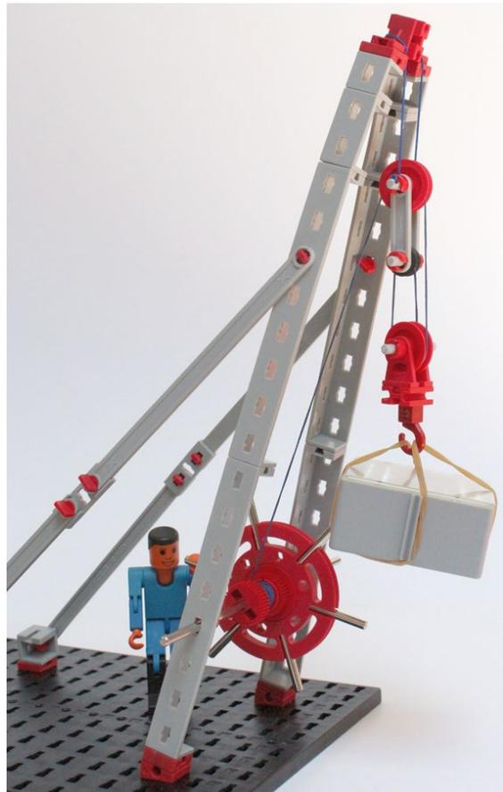
Abb. 1–4 fischertechnik-Modell eines *Trispastos*
