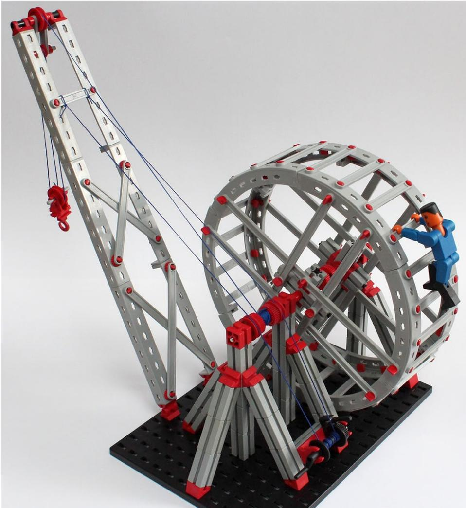
Abb. 1–22 fischertechnik-Tretradkran mit dreifachem Flaschenzug
