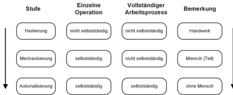
**Bild 1.1** Entwicklungsschritte der Automatisierungstechnik
