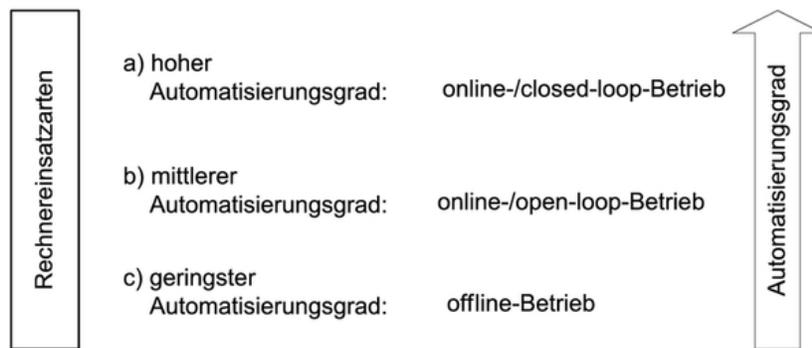
**Bild 1.4** Automatisierungsgrad
