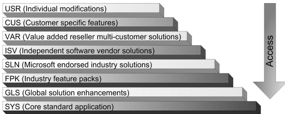
**Abbildung 1-2:** Layer-Konzept mit den Anwendungsschichten in Dynamics AX 2012
