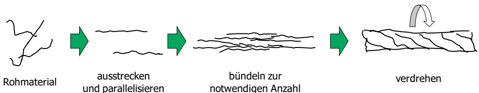
Bild 1.3 Prozess der Entstehung von Garn aus Einzelfasern
