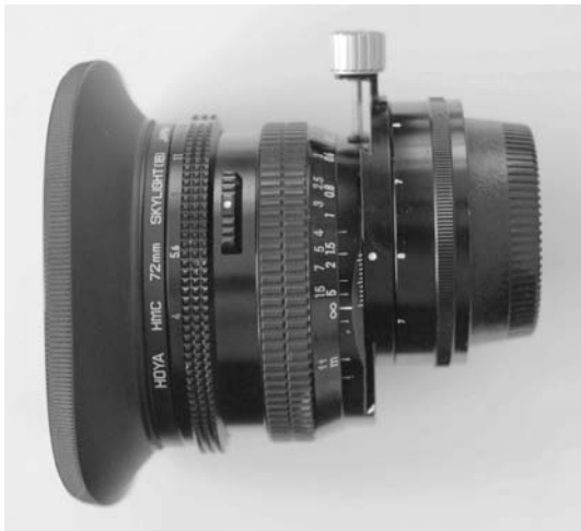
Bild 2.3.1.13 Shift-Objektiv (PC-Nikkor) im verschobenen Zustand
