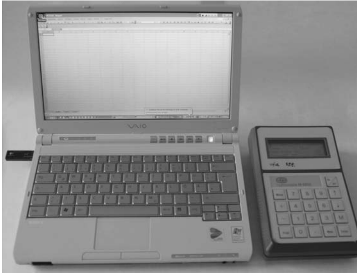
Bild 2.3.1.18 Kombination Notebook-Feuchte- und Klimameßgerät Als Beispiel Sony VGN-TX2HP mit Bluetooth -Schnittstelle und GANN M 4050
