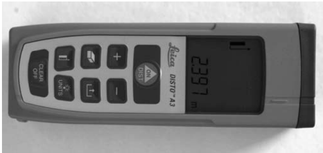
Bild 2.3.1.1 Laser-Messgerät „Leitz DISTOTM A3“
