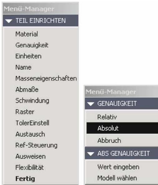
**Abb. 3-01: Menü-Manager im Teilemodus von Pro/ENGINEER.** Aus dem Menü-Manager „TEIL EINRICHTEN“ werden die für MECHANICA wesentlichen Einstellungen bzgl. Material, Genauigkeit und Einheiten vorgenommen.
