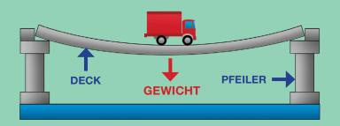
Wenn die Pfeiler einer Balkenbrücke zu weit voneinander entfernt sind, hängt das Deck durch. Kompressionskräfte drücken auf die Oberseite des Brückendecks, während Spannkräfte seine Unterseite dehnen. Diese rivalisierenden Kräfte können das Deck auseinanderreißen!
