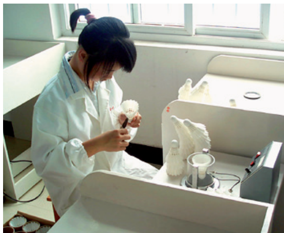
Abb. 11: In der Federballfabrik im chinesischen Nanjing, wo Victor seine Bälle produzieren lässt, wird der Abstand der Federn jedes einzelnen Balls manuell kontrolliert.
