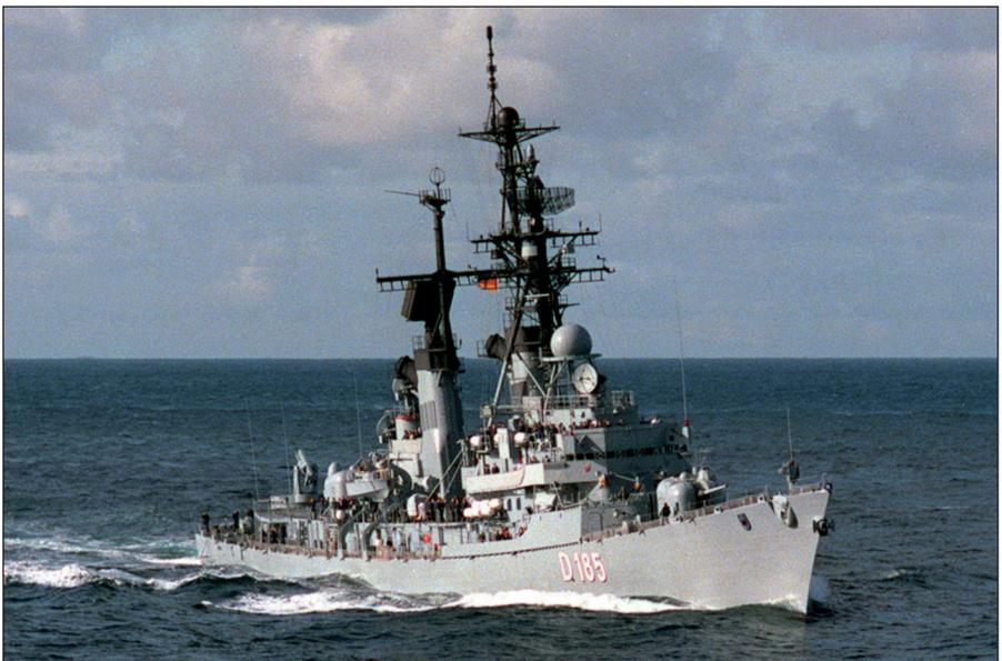
Die »Lütjens« und ihre Schwesterschiffe waren die ersten Einheiten der Bundesmarine mit Flugkörperbewaffnung sowie einem Führungs- und Waffeneinsatzsystem (SATIR). (Bild: US Navy)
