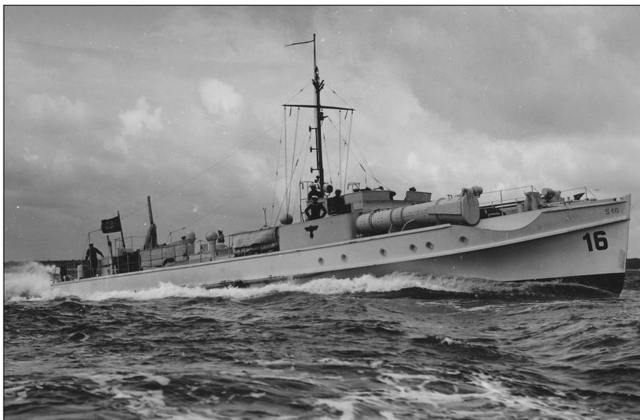
S-14 bis S-17 erreichten mit MAN-Dieseln eine Kurzhöchstfahrt von 37,5 kn. (Foto: BfZ)
