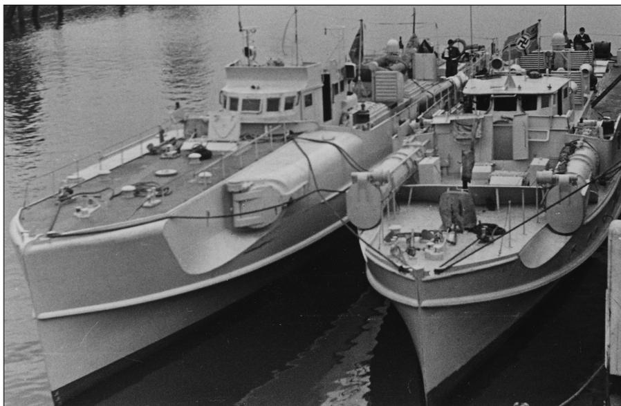
Diese Aufnahme verdeutlicht den Unterschied zwischen der Serie S-26 bis S-29 (links) mit erhöhter Back und innen liegenden Torpedorohren sowie der Baureihe S-6 bis S-13. (Foto: BfZ)
