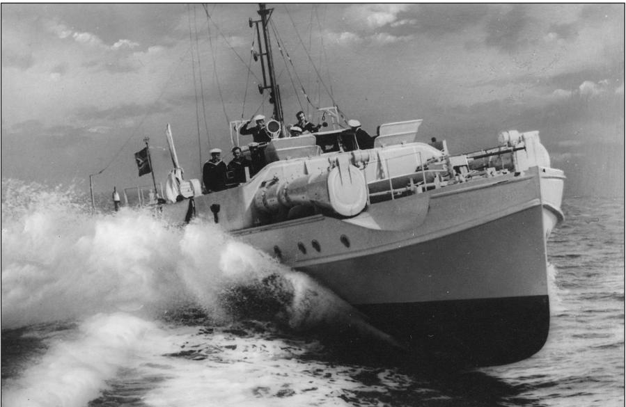
S-22 und seine Schwesterboote erreichten mit Daimler-Benz-Dieseln eine Dauerhöchstfahrt von 38,5 kn und eine Kurzhöchstfahrt von 39,5 kn. (Foto: BfZ)
